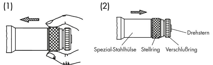
Das Universal-Mundstück besteht aus: Spezial-Stahlhülse, Stellring komplett, Drehstern und Verschlussring.
