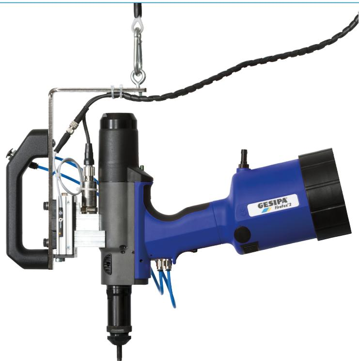
Variante mit Andrucküberwachung und Zähler
