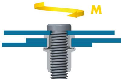
Anschließend wird die Schraube wieder ausgeschraubt. Das Gewinde muss weiter leichtgängig sein, um die Prüfung zu bestehen. Danach wird die Blindnietmutter bis zum Überdrehmoment belastet.
